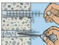
2. Bohrlöcher sorgfältig mit Stahlbürste und Ausbläser reinigen
