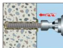
4. Ankerstange drehend schlagend eintreiben bis Markierung bündig mit der Betonoberfläche ist
