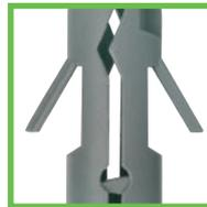
**Die beiden Schwerter** verhindern das Mitdrehen im Bohrloch.
