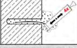
Anschließend das Bohrloch erneut vom Bohrlochgrund her mit der Ausblaspumpe **4x** vollständig ausblasen.
