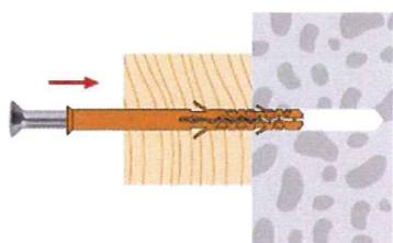
Fassadendübel mit vormontierter Schraube
