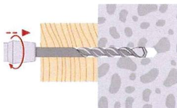
Bohrlocherstellung im Hammerbohrverfahren
