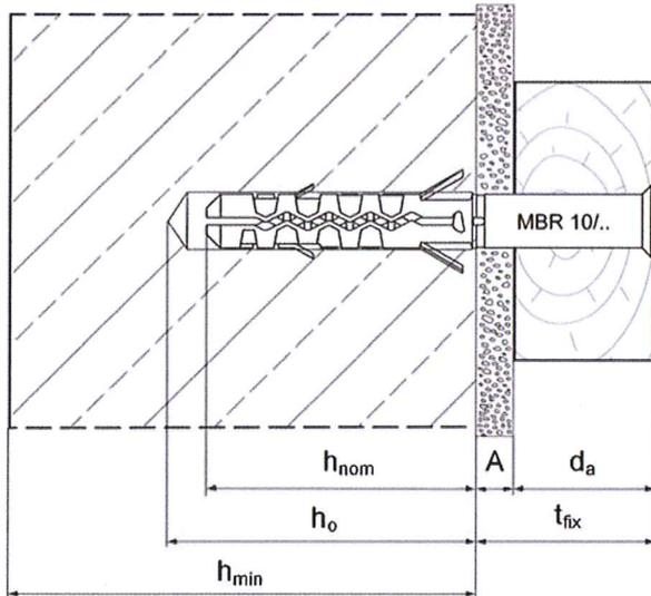
Einbau in Beton und Vollstein (Bsp. MBR 10)
