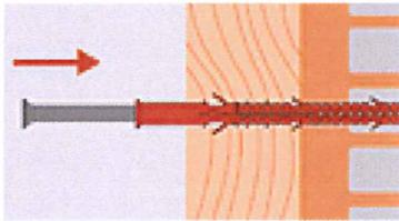
Fassadendübel mit vormontierter Schraube durch zu befestigendes Bauteil einsetzen
