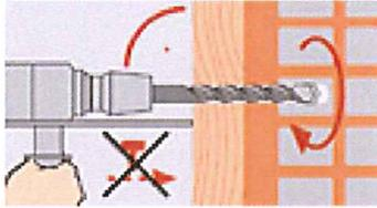
Bohrlocherstellung im Drehbohrverfahren (Bohren ohne Hammerschlag)
