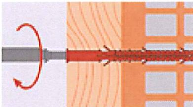
Fassadendübel bis Bund auf Bauteil stecken, dann Bauteil mit Schraube befestigen
