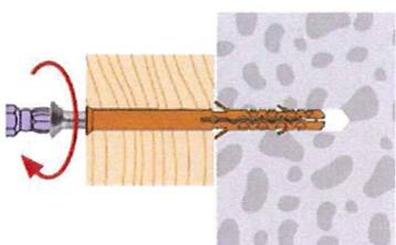
Fassadendübel bis Bund auf Bauteil stecken,
